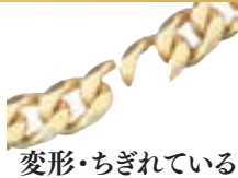
変形・ちぎれている
