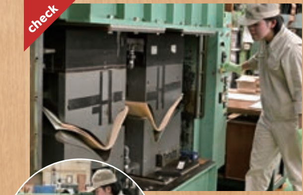
バタフライスツールは薄さ1mmの単板7枚と表面材を重ねて接着し、専用のプレス機で成形。板の様子・音などで判断しながら少しずつ圧を調整する見事な職人技です。
