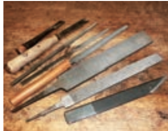
製管のための道具類。ノミや何種類ものヤスリなど使い込まれた風合いが美しく、丁寧に手入れされた様子が伺える。
